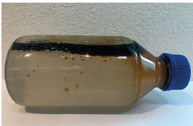
Bild 2: Kondensat besteht bei öleingespritzten Systemen aus Wasser, Partikeln und Öl
